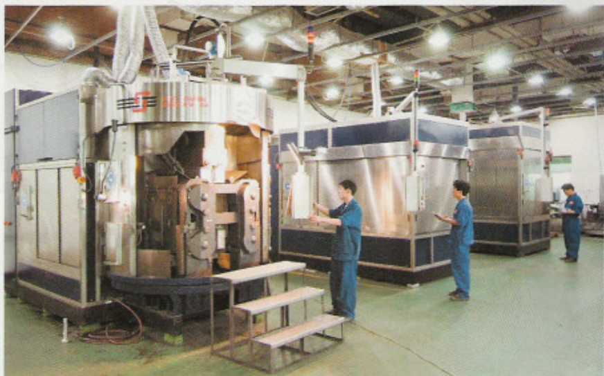
...die Blöcke mit Drahtsägen aus der Schweiz in mikrometerdünne Siliziumscheiben (Wafer) zerschneidet,...
