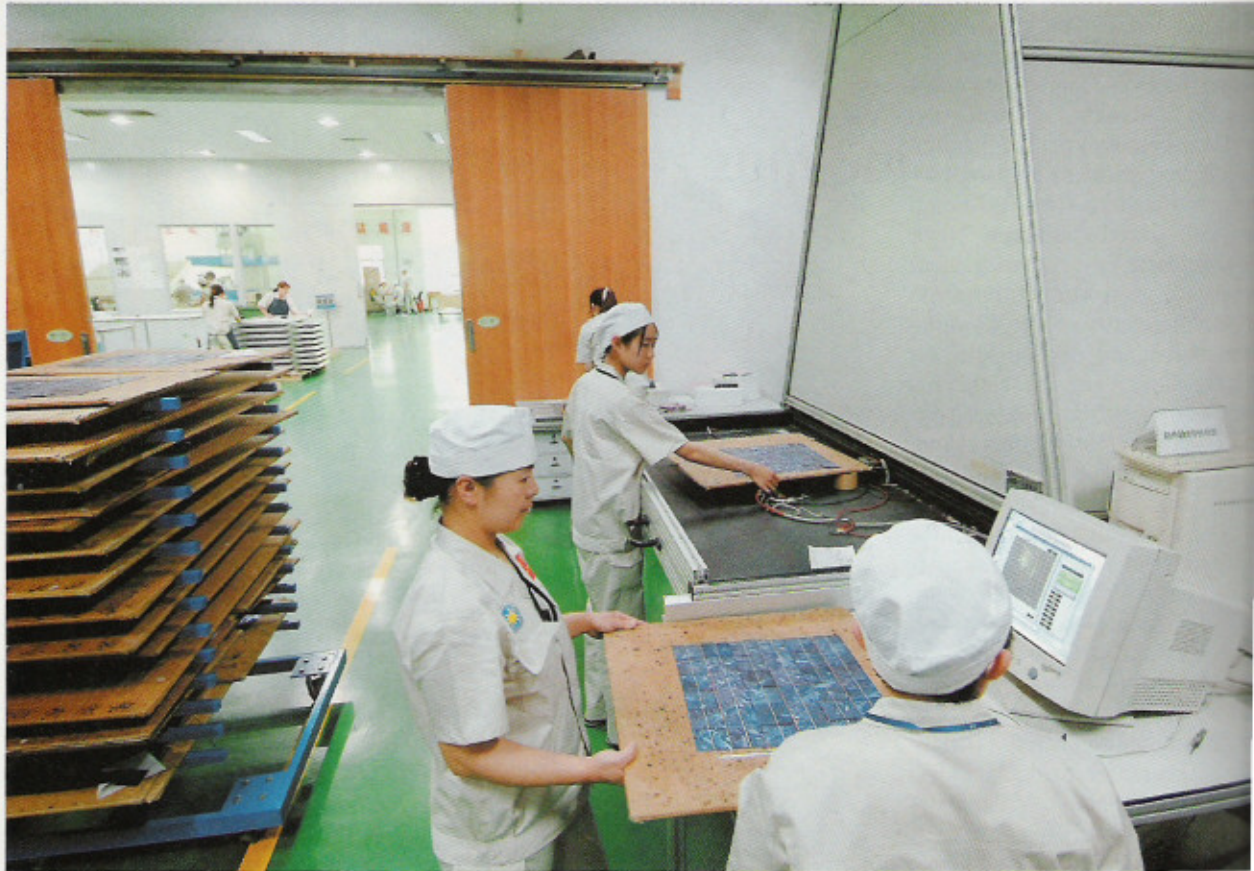
Die ersten Geräte für seine Modulproduktion hat Baoding Tianwei Yingli vom italienischen Modulhersteller Helios gekauft. An diesem Solarsimulator messen Mitarbeiterinnen die elektrischen Kennlinien der Solarmodule.
