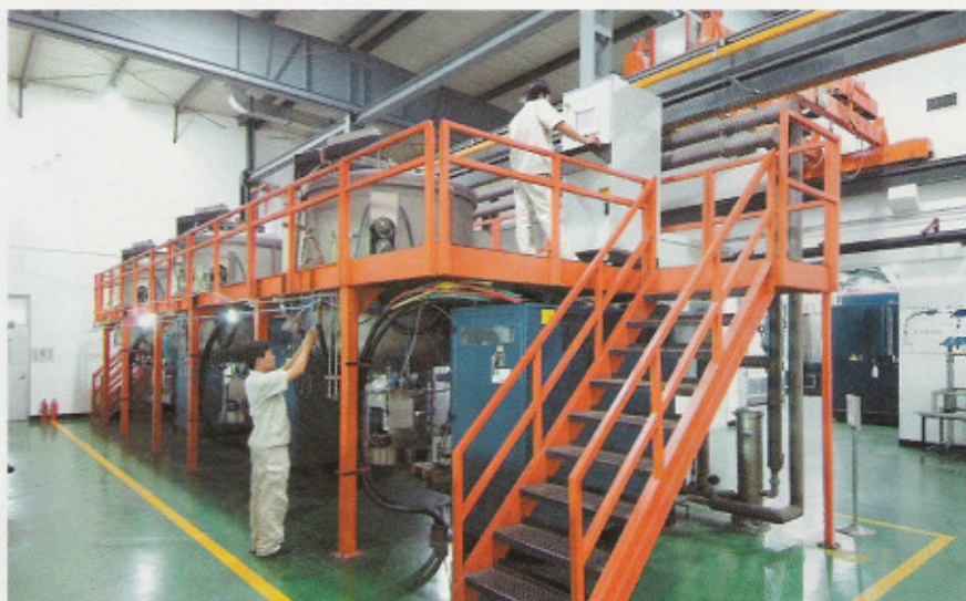
Vollintegriert: Baoding Tianwei Yingli ist Chinas erster Solarmodulhersteller, der selbst multikristalline Kristallblöcke zieht – hier abgebildet sind drei Öfen jeweils mit einer Kapazität von zwei Megawatt –...
