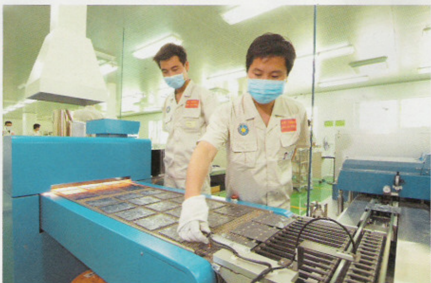
...die dann weiter zu Solarzellen prozessiert werden. Hier stehen zwei Mitarbeiter vor einem Sinterofen zum Einbrennen von Zellkontakten.
